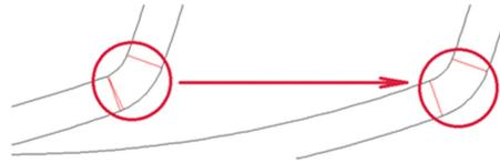
**Ausrunden:** Entfernen eines Korrektur-elementes, das durch nichttangente Anschlüsse in der CAD-Zeichnung entstanden ist
